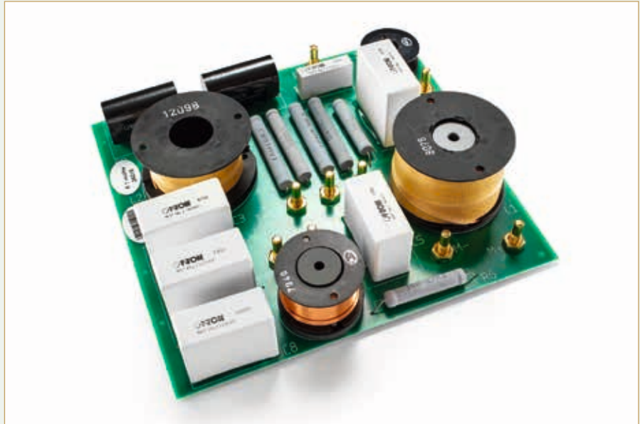
Als Frequenzweiche kommt eine Baugruppe zum Einsatz, die im Linkwitz/Riley-Stil, also einer Flankensteilheit von satten 24 dB pro Oktave operiert
