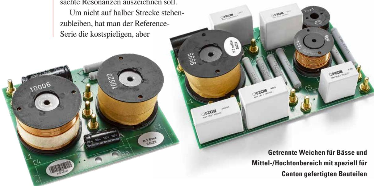
Getrennte Weichen für Bässe und Mittel-/Hochtonbereich mit speziell für Canton gefertigten Bauteilen
